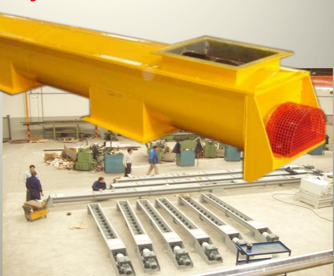
Nous concevons et construisons des convoyeurs à vis tubulaires et de type cuve de différents diamètres et de type filet selon le matériel à transporter. Ils sont également fabriqués en fer anti-usure pour le matériel comportant un indice d'abrasion important. Nous disposons d'une excellente conception optimisée durant des années pour obtenir un rapport qualité/prix optimal sur toute notre ligne de filetages.
