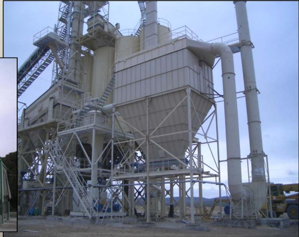
Calculs, fabrication et montage de réseau de tuyauteries d'aspiration, fabriquées en tôle galvanisée ou en acier au carbone. Nous disposons d'une large gamme de modèles avec une aire filtrante allant de 130 à 1400m<sup>2</sup> et des design adaptables aux nécessités de chaque client.
