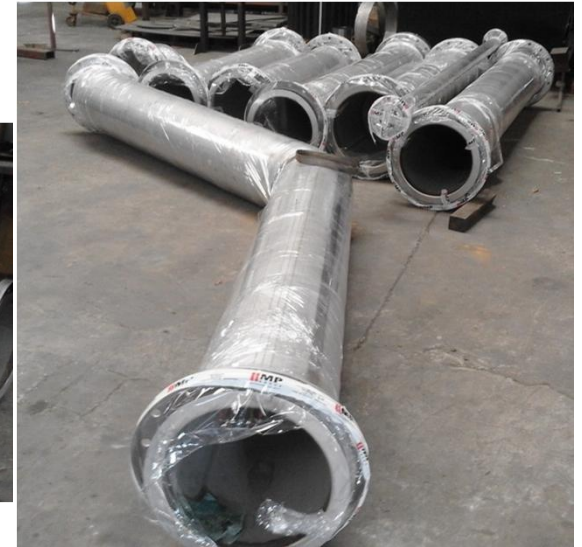
FABRICACION EN INOX. AISI 316 PARA ING. INCLAM SISTEMA DE AGUA POTABLE PARA CATACAMAS (HONDURAS)
